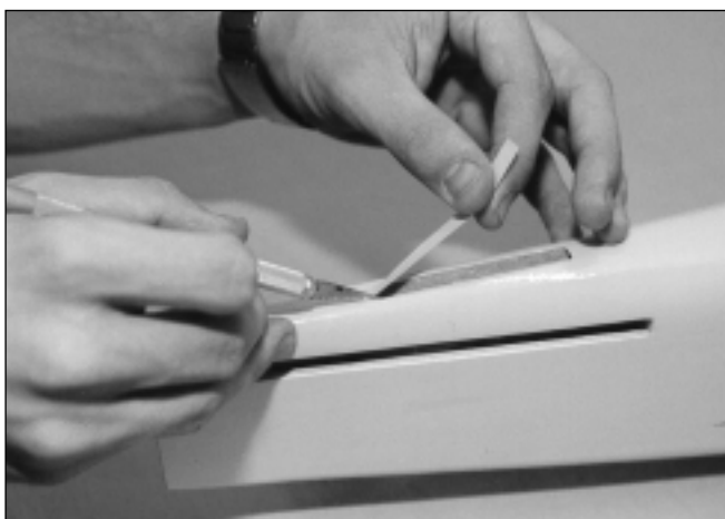
1 - Découper l'entoilage délicatement au niveau des fentes ménagées à l'arrière du fuselage. Ces fentes correspondent au passage de la dérive et du stabilisateur.
