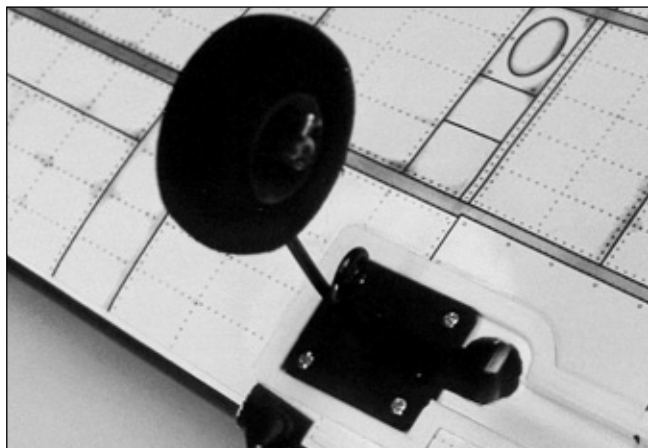
12 - TRAIN RENTRANT - Mettre votre train rentrant en place sans le fixer, repérer les jambes pour pouvoir les plier et les couper. Ouvrir l'aile à l'emplacement du servo (servo très faible hauteur spécial train : mettre le servo à l'endroit, le fixer directement sur les baguettes de l'aile. Pour un servo standard, le mettre à l'envers et recoller deux morceaux de baguette sur le coffrage pour visser le servo).
