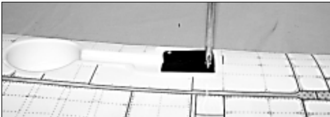
2 - Visser dans cette demi-aile gauche le boîtier de train rentrant.
