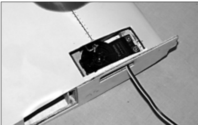
4 - Placer le servo de train rentrant sur ses supports et installer la tringlerie du mécanisme de rétraction. Pour ce faire, il vous faut vous rapprocher de la notice spécifique du fabricant du train que vous aurez installé. Si vous installez un train rentrant Air Loisirs, les logement et emplacement
