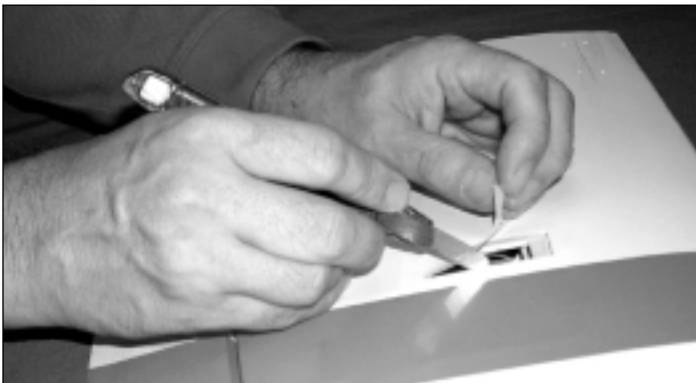
3 - A l'intrados de chaque aile, découper l'entoilage au niveau du logement du servo d'aileron.
