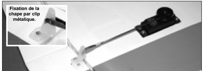
6 - Installer le servo d'ailerons après avoir tiré le câble à l'intérieur de l'aile. Fixer le guignol sur l'aileron avec les vis M2 x 25 mm. Préparer la tringlerie d'ailerons, avec la partie filetée et chape côté gouverne, et un pliage en "Z" côté palonnier de servo après avoir détrempe la corde à piano en la chauffant. La chape métallique pourra être assurée par les clips fournis, ou, plus traditionnellement avec un morceau de durite (non fourni).
