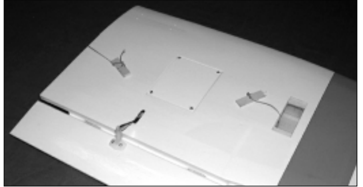
5 - Un tire câble d'ailerons est installé d'origine dans l'aile, il est muni à chaque extrémité d'un petit morceau de contre-plaqué collé à la structure. Il suffit de forcer un peu pour les décoller.
